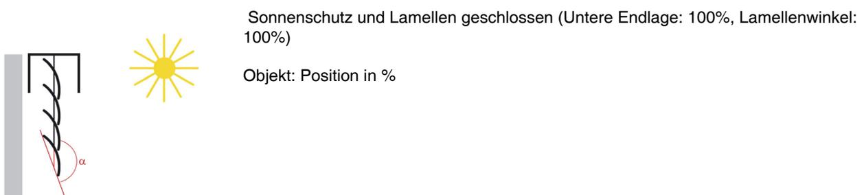
Aus ihrer senkrechten Stellung (vollständig geschlossen, 100%) können die Lamellen bis zu ihrer waagerechten Stellung (vollständig geöffnet, 0% bzw.  $= 90^\circ$ ) verstellt werden. Der verwendete Jalousie-Antrieb bestimmt hierbei, ob dieses Verstellen nahezu stufenlos in vielen kleinen Schritten erfolgen kann oder ob dies nur in wenigen großen Schritten möglich ist (Wie bei den meisten Standard-Antrieben).
