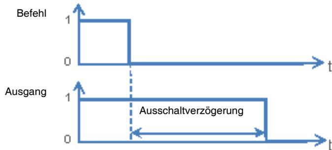
**Ein- und Ausschaltverzögerung:** Ermöglicht die Parametrierung einer Verzögerung zwischen dem Einschaltbefehl und der Umschaltung des Ausgangskontakts, sowie zwischen dem Ausschaltbefehl und der Umschaltung des Ausgangskontakts.
