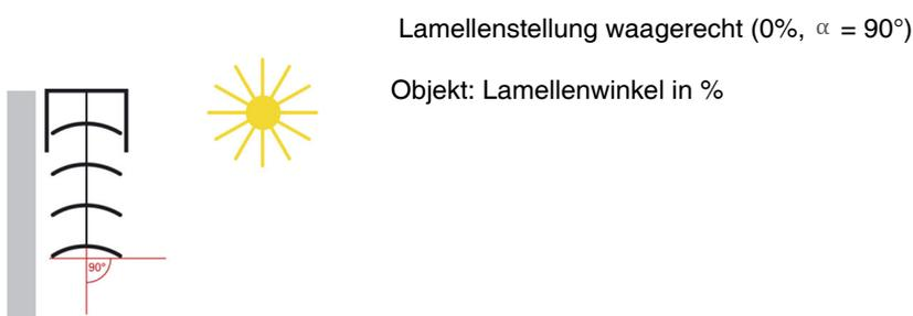
Bei Standard-Jalousien können die Lamellen über ihre waagerechte Stellung hinaus so lange weiter verstellt werden, bis die Lamellen-Verstellung endet und das Hochfahren der Jalousie beginnt. Die Lamellen bilden dann mit der Senkrechten einen Winkel zwischen  $0^\circ$  und  $90^\circ$ .
