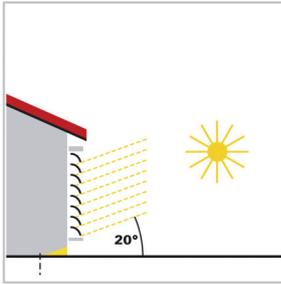
Der Sonnenschutz wurde automatisch weiter herab gefahren, damit die maximal zulässige Eindringtiefe der Sonne in den Raum nicht berschritten wird. Die Lamellen wurden automatisch ein Stück weit geschlossen, damit die Sonne nicht direkt in den Raum scheinen kann. Trotzdem kann diffuses Tageslicht weiterhin in den Raum gelangen und so zur Raumbelichtung beitragen (Tageslichtnutzung).
