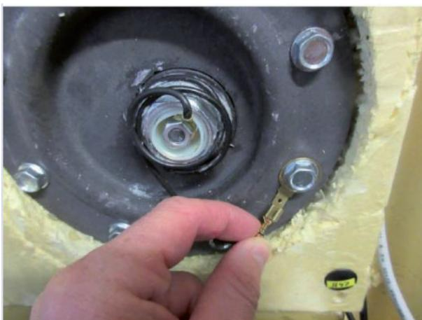
Abschließend muss noch das Netzteil beim Schuko-Stecker eingesteckt werden, und die Fremdstrom Schutzanode ist voll einsatzfähig.
