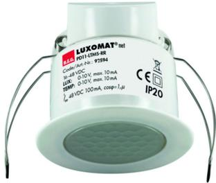
Besonders flacher Multisensor zur Erfassung von Präsenz, Temperatur- und Helligkeitswerten -Zur Integration in ein proprietäres Bussystem -Ausgabe der Bewegungserkennung über Schaltkontakt -Ausgabe des aktuellen Licht- und Temperaturwertes als Analogspan
