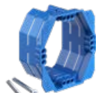
UP 1 Putzausgleich-Rahmen · Stufenloser Putzausgleich von 10 – 35 mm Art. 1155-65
