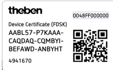
Die ETS erzeugt nach Eingabe des FDSK einen gerätespezifischen Werkzeugschlüssel. Über den Bus sendet die ETS den Werkzeugschlüssel zum Gerät, das konfiguriert werden soll. Die Übertragung wird mit dem ursprünglichen und vorher eingegebenen FDSK-Schlüssel verschlüsselt und authentifiziert. Weder der Werkzeug- noch der FDSK-Schlüssel werden im Klartext über den Bus gesendet.
