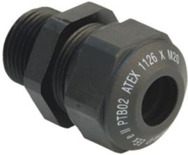
AGRO Kabelverschraubungen Progress® Kunststoff GFK erhöhte Sicherheit Ex e II, Anschlussgewinde metrisch, Schwarz RAL 9005 Exe II Kabel Ø4.5-6.0mm, 3 = Material Dichteinsatz NBR
