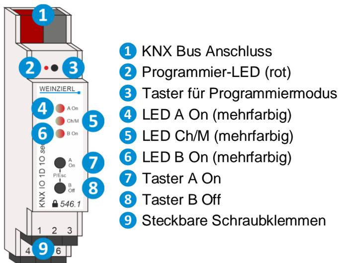
Da dieses Gerät vom Bus versorgt wird, ist der Anschluss einer externen Versorgungsspannung nicht erforderlich.
