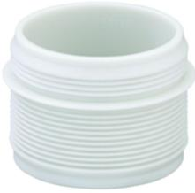
Kombistutzen KST M32, Kombistutzen, zur Verbindung von Gehäusen, Thermoplast, Schutzart IP54, für Wandstärke 1,5 - 4,0 mm,
