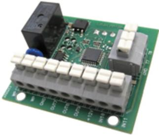
AEREX Regelung SAT BA/KW Zusatzrelais zu Ansteuerung von max.2 externen Tauschern
