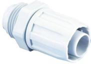
Kunststoff-Schlauchverschraubung mit integrierter Innentülle und drehbarem Anschlussgewinde, zur Montage von passenden Schutzschläuchen. Ausgelegt nach den Vorschriften der EN 60204 für den Maschinen- und Anlagenbau.
