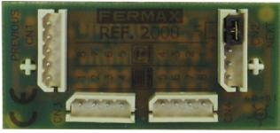
**FERMAX Erweiterungsmodule für den Anschluss von bis zu 8 Ruftasten**
