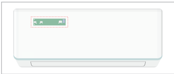
Abb. 28: Eibauposition der Adapterplatine
