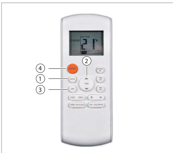
Abb. 11: Modus "Kühlen", "Heizen" und "Umluft"
