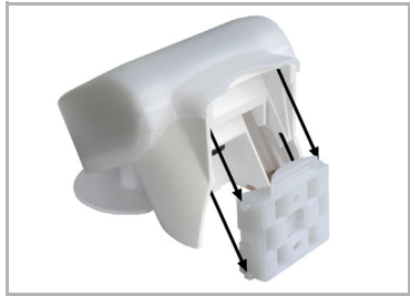
Abb. 17 Schieben Sie das Gehäuse von oben in den montierten Halter. Die Zapfen des Halters müssen dabei in den Schienen des Gehäuses einrasten.
